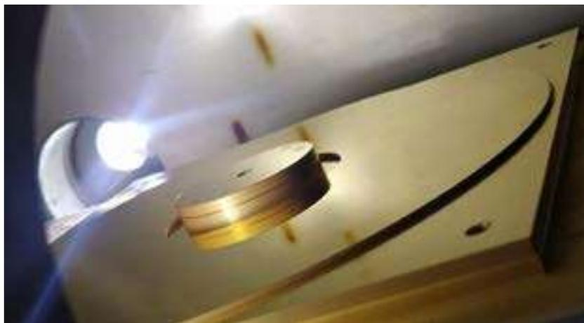
Um die hohen Anforderungen an Homogenität und Reinheit der Goldschicht einzuhalten, kam nur das Sputtern im Vakuum als Beschichtungsverfahren infrage. (Bild: Magtec)
